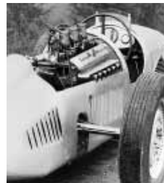
Ungewöhnliche Konstruktion: der BMW 328 Motor im Heck des Monopol.
